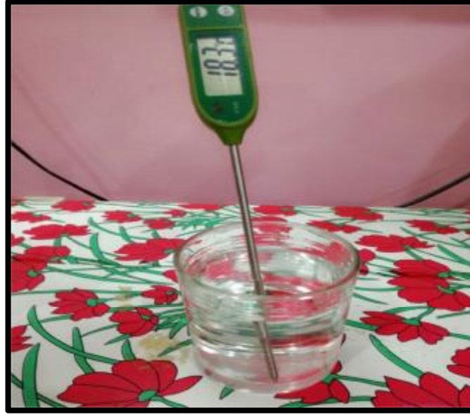
شكل (٩) يوضح آلية قياس حرارة السائل باستخدام الكتروني خاص
